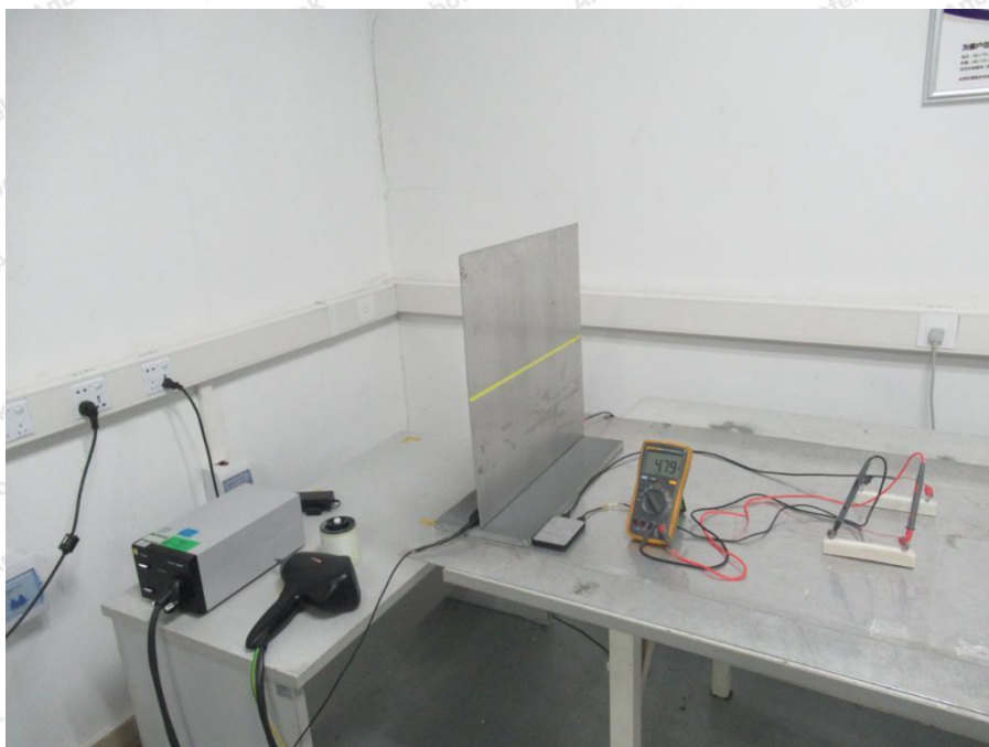
PhotoofElectrostaticDischargeImmunityTest
